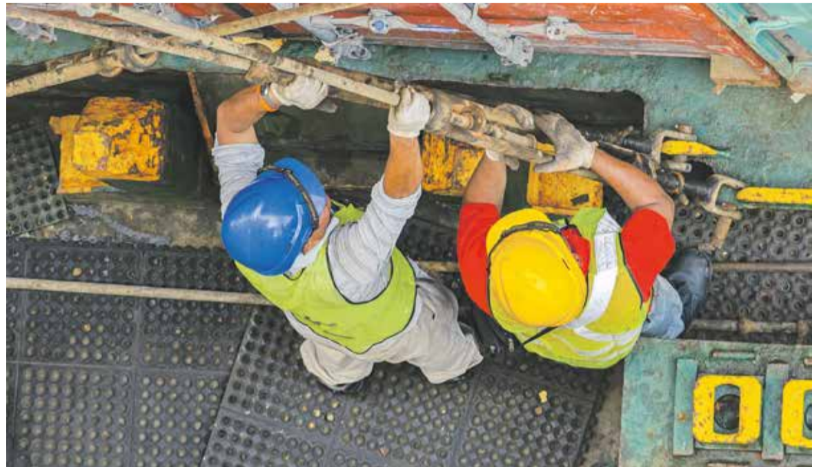
Er wordt vaak varend gesjord zodat op de terminal het lossen meteen kan beginnen. Foto: Shutterstock
